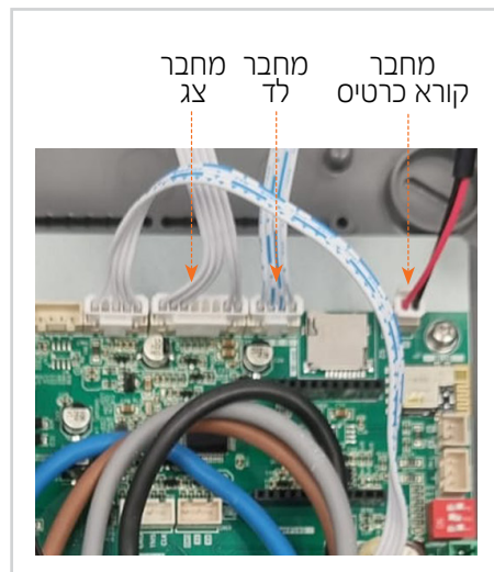
4. נתקו בזהירות את 3 הכבלים המחוברים למכסה - קורא כרטיס, לד וצג. כעט ניתן להסיר את המכסה
